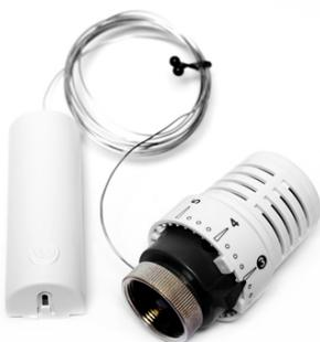
Quando ciò non è possibile si consiglia l'adozione del modello **ATSDW testina termostatica con sensore remoto**, separato dall'elemento di trasduzione mediante un capillare a riempimento di liquido.
