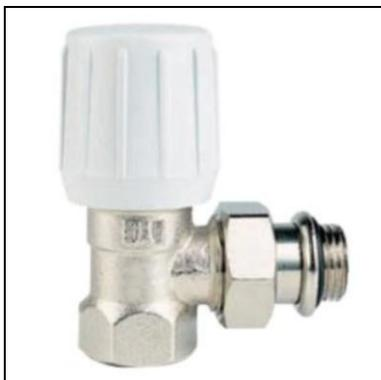
Le valvola termostattizzabili **VSQ** e **VDR**, sono utilizzate come organi di intercettazione e di regolazione per corpi scaldanti (radiatori, convettori, tubi alettati, etc) in abbinamento agli attuatori termostatici **ATW** ed agli attuatori elettronici.
